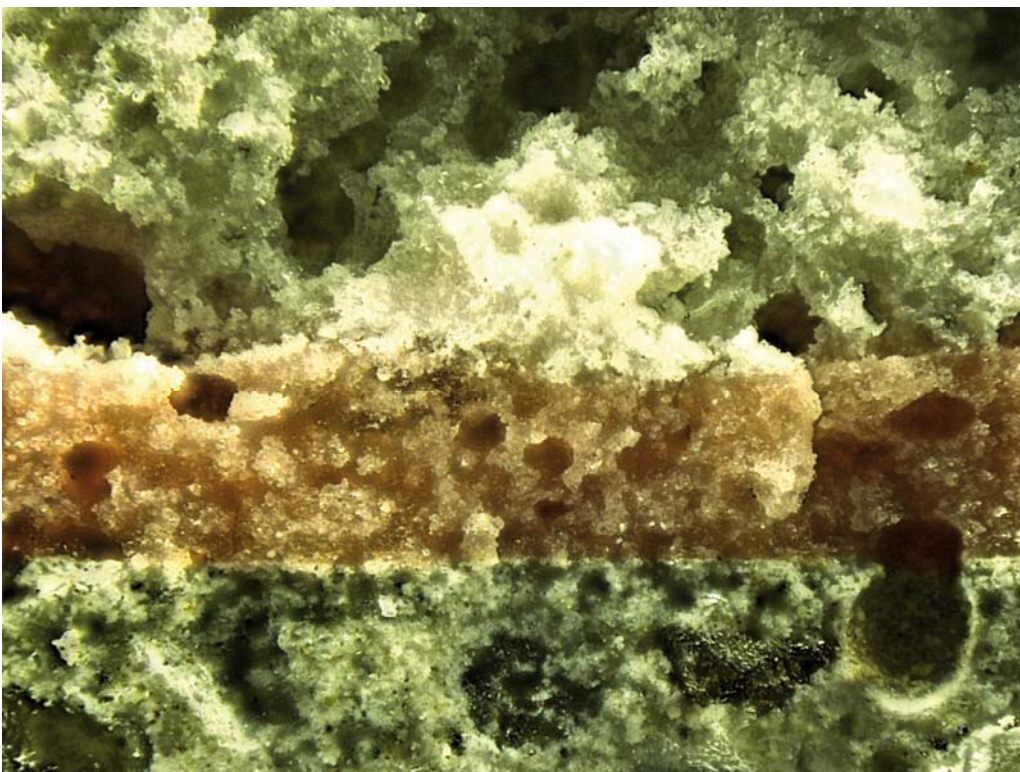
betoni + orgaaninen pohjuste ja kipsirappaus 200 kertainen suurennos
